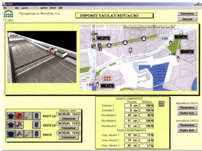
Pantalla principal de Scada del depósito de Taulat
